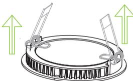
4. Cuando los resortes estén asegurados tocando la entrada del hueco, suelte los resortes y con mucho cuidado y fuerza, empuje el panel dentro del hueco, gracias a un movimiento usted se dara cuenta de cuando el panel esté asegurado.
