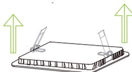
4. Cuando los resortes estén asegurados tocando la entrada del hueco, suelte los resortes y con mucho cuidado y fuerza, empuje el panel dentro del hueco, gracias a un movimiento usted se dará cuenta de cuando el panel esté asegurado.
