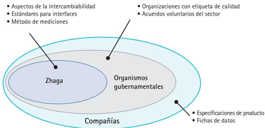
\* Un mecanismo de iluminación LED consiste en la combinación de un módulo LED y su dispositivo de control asociado. Zhaga considera el mecanismo de iluminación LED como una caja negra, con interfaces definidas que no dependen del tipo de tecnología LED que se utiliza dentro del mecanismo de iluminación. Las especificaciones de Zhaga definen tan sólo el exterior de los mecanismos de iluminación LED.
